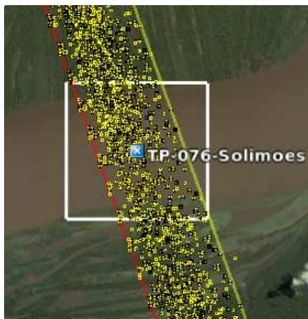
FIG. 3.4: Illustration d'une fenêtre géographique d'extraction sur le fleuve Solimões (Brésil) pour la station virtuelle « TP-076-Solimoes » : Accumulation des mesures à 10Hz obtenues par Topex/Poseidon sur la trace 76 de sa première orbite (1993-2002). Les traits obliques de gauche et de droite représentent respectivement les limites Ouest et Est de la trace, extraites depuis quelques cycles. (Image GoogleEarth).
